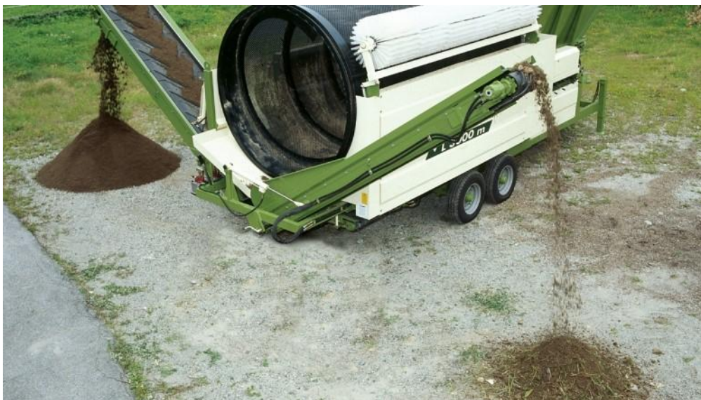
Фигура 32. Барабанно сито, предвидено за употреба на съоръжението за компостиране
