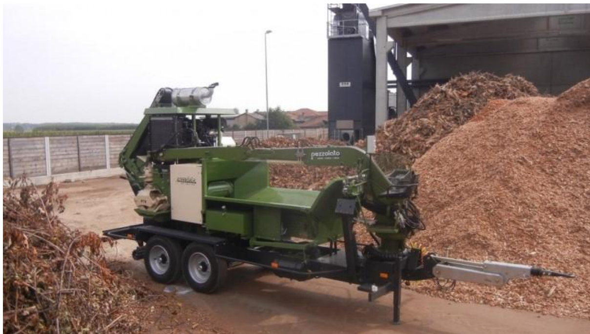
Фигура 31. Подвижен шредер, предвиден за употреба и на двете съоръжения за компостиране
